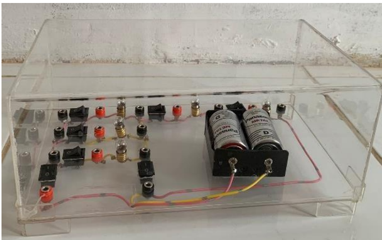
Gambar 4.5 Alat peraga rangkaian listrik yang sudah divalidasi
